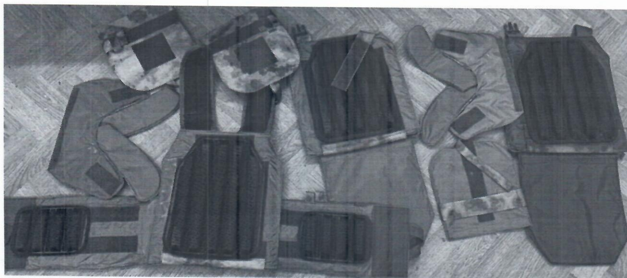
Фото 2. Внешняя и тыльная сторона секций БЖ «КОБАЛЬТ-МП» после испытаний (+40°С, -40°С и воде).
